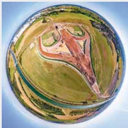
OU Wedringen: Es wurde immer am gleichen Punkt gestartet und auf 100 m über Grund geflogen. Die generierten Panoramen sind georeferenziert und eingenordet. Dadurch lassen sich die Einzel-Planets zu einer Zeitraffer-Sequenz zusammenfassen, mit der die Verfolgung des Baufortschritts über einen längeren Zeitraum möglich ist.
