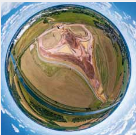
OU Wedringen: Es wurde immer am gleichen Punkt gestartet und auf 100 m über Grund geflogen. Die generierten Panoramen sind georeferenziert und eingenordet. Dadurch lassen sich die Einzel-Planets zu einer Zeitraffer-Sequenz zusammenfassen, mit der die Verfolgung des Baufortschritts über einen längeren Zeitraum möglich ist.
