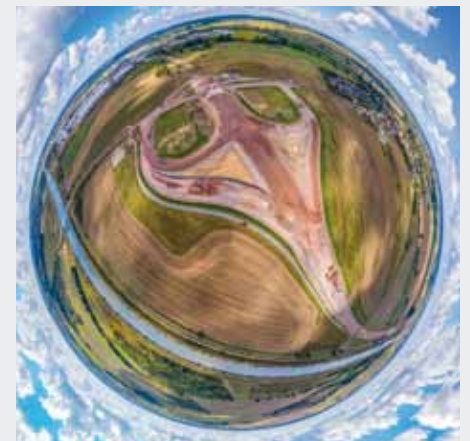
OU Wedringen: Es wurde immer am gleichen Punkt gestartet und auf 100 m über Grund geflogen. Die generierten Panoramen sind georeferenziert und eingenordet. Dadurch lassen sich die Einzel-Planets zu einer Zeitraffer-Sequenz zusammenfassen, mit der die Verfolgung des Baufortschritts über einen längeren Zeitraum möglich ist.
